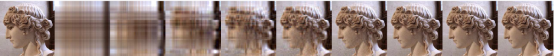
Rys. 10.3. Zastosowanie rozkładu SVD do analizy obrazów. Obraz można interpretować jako (dużą) macierz (lub kilka macierzy), której elementami są liczby odpowiadające jasności danego piksela albo współrzędnymi RGB. Pierwszy rysunek pokazuje oryginalny obraz (macierz RGB) a następne w kolejności zredukowany rozkład SVD tego obrazu obcięty do 1, 2, 4, 8, 16, 32, 64, 128 największych wartości szczególnych. Ostatni rysunek otrzymano z pełnego rozkładu SVD.
